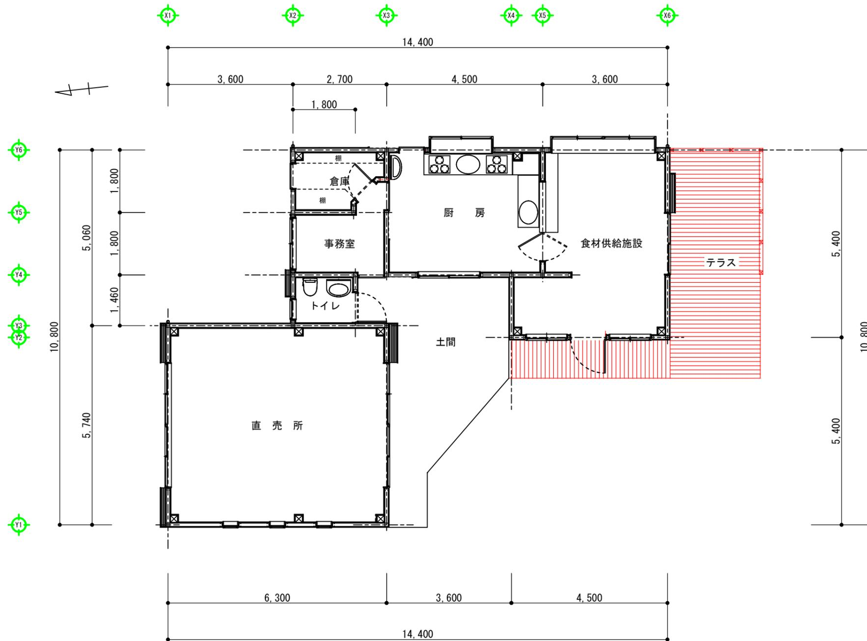
1階平面図 SCALE : 1/100
