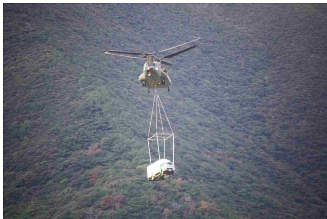
画像 5-7. 自衛隊ヘリによる全国初の高圧発電機車の移送
